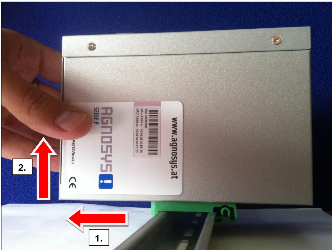
Demontage von der Hutschiene
