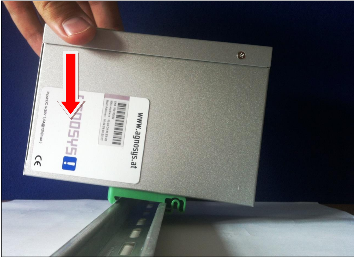
Montage auf der Hutschiene
